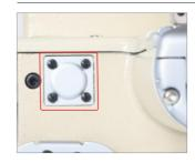
精心改良的送布牙连动机构,有效的避免了送布牙间隙过大的情况,机器运转无卡点,机器性能更稳定,延长机器使用寿命。
