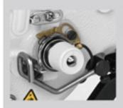
配备断线检知功能,车缝过程中断线立即停止,可退针接缝,不需重新车缝,大大提升车缝效率
